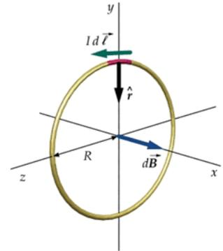
Si el dispositivo consta de **N espiras paralelas muy próximas**, enrolladas alrededor de un cilindro, recibe el nombre de **bobina**, y el módulo del campo magnético creado en su centro es:
