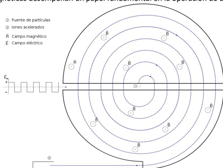
En cada salto entre “Des” la carga incrementa su energía cinética en la cantidad  $q\Delta V$ . Cuando el radio de su trayectoria es prácticamente el de las “des”, el ion sale del sistema a través de la ranura de salida. **Obsérvese que la operación del ciclotrón se basa en que T es independiente de la rapidez del ion y del radio de la trayectoria circular.**
