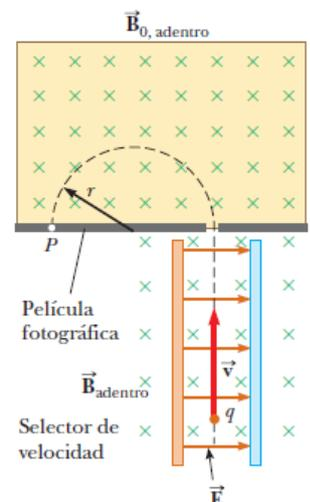
De  $r = \frac{mv}{qB}$ ;  $v = \frac{rqB}{m}$  y  $v^2 = \left(\frac{rqB}{m}\right)^2$  por lo tanto  $\frac{1}{2}m\left(\frac{rqB}{m}\right)^2 = q\Delta V$  simplificando esta ecuación y despejando  $m/q$
