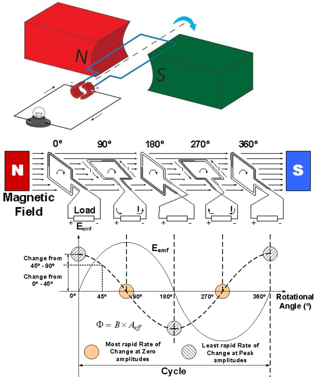
**Generación de corriente alterna por rotación de una espira en el interior de un campo magnético uniforme. (La variación del flujo magnético es debida a la diferente dirección de la superficie que presenta la espira en cada instante).**
