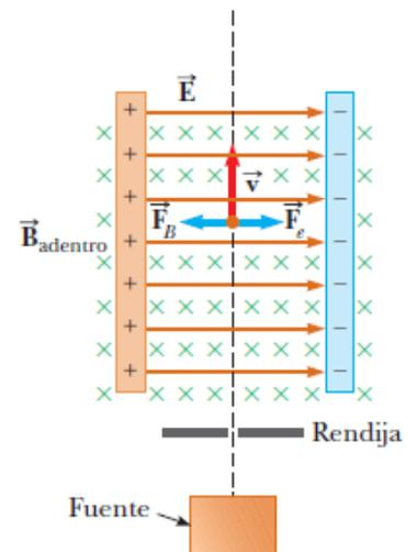
perpendicular al campo magnético, los campos eléctrico y magnético deben ser perpendiculares entre sí, para que se contrarresten estas fuerzas. La figura muestra una región del espacio entre las placas de un condensador en el cual existe un campo eléctrico y un campo magnético perpendicular (que puede producirse por un imán indicado).
