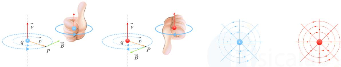
A diferencia de las líneas de campo eléctrico que son radiales y abiertas, las líneas del campo magnético son circunferencias perpendiculares al vector velocidad y con centro sobre la dirección de la velocidad. Las líneas de campo coinciden con las líneas azules punteadas de la figura.
