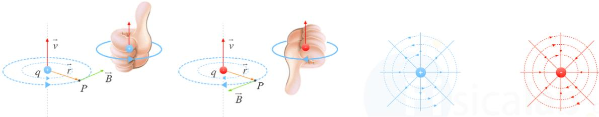
A diferencia de las líneas de campo eléctrico que son radiales y abiertas, las líneas del campo magnético son circunferencias perpendiculares al vector velocidad y con centro sobre la dirección de la velocidad. Las líneas de campo coinciden con las líneas azules punteadas de la figura.
