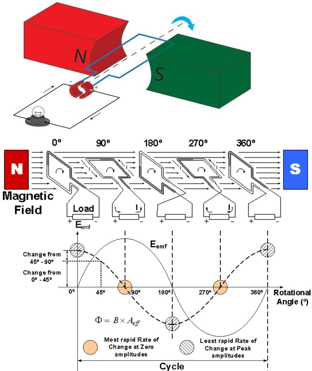
**Generación de corriente alterna por rotación de una espira en el interior de un campo magnético uniforme. (La variación del flujo magnético es debida a la diferente dirección de la superficie que presenta la espira en cada instante).**
