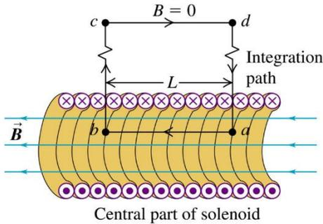
Si trazamos como línea de integración (“amperiana”) la pintada de color en la figura, la integral  $\oint \vec{B} \cdot d\vec{r}$  la podríamos descomponer en suma de 4, una por cada tramos recto. Si suponemos que en el interior el campo magnético es constante y en el exterior es 0, nos queda:
