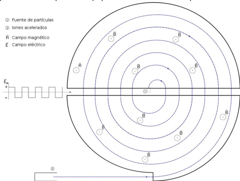
En cada salto entre "Des" la carga incrementa su energía cinética en la cantidad qΔV. Cuando el radio de su trayectoria es prácticamente el de las "des", el ion sale del sistema a través de la ranura de salida. **Obsérvese que la operación del ciclotrón se basa en que T es independiente de la rapidez del ion y del radio de la trayectoria circular.**
