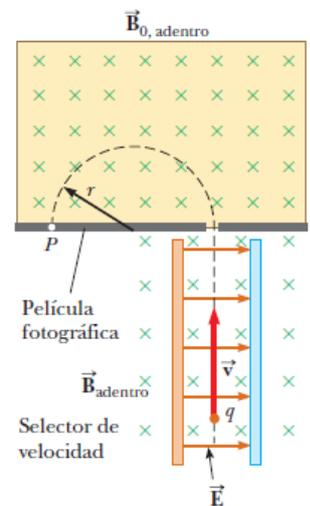
Relación que nos permite calcular la relación m/q de los iones del aparato. La abundancia de cada uno se puede apreciar por el grosor de la marca que los isótopos dejan al llegar a la pantalla.
