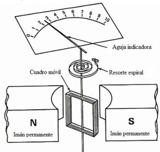
magnéticas que actúan sobre las espiras del cuadro. El movimiento del cuadro se transmite a una aguja que indica sobre una escala graduada la intensidad de la corriente eléctrica.
