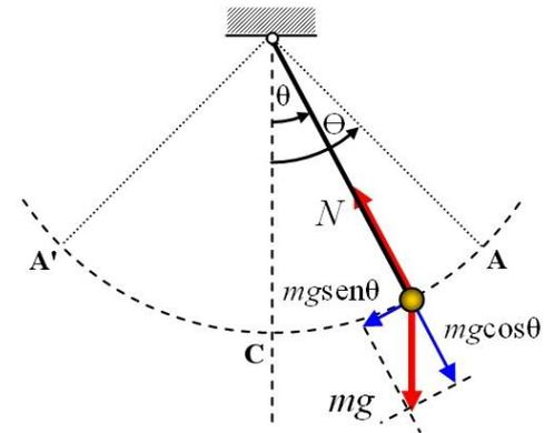
El péndulo simple está formado por una masa "m", suspendida de un punto fijo "O" por medio de un hilo inextensible de masa despreciable y longitud "l", que oscila alrededor de otro punto fijo en la misma vertical que "O".
